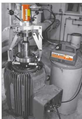
Для выпрессовки подшипника из двигателя насоса зумпфа применялось устройство модели SGH153CR с вспомогательной насадкой для выпрессовки подшипников
